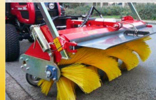
K 560 mit verstellbarem Spritzschutzblech
