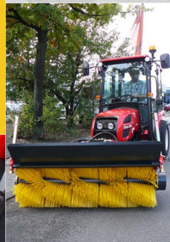
Großer Auswurfwinkel im Maschinenrahmen – ideal zum Schneekehren
