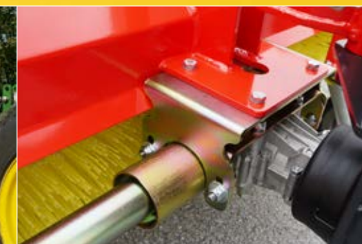
Drehzahl, Drehrichtung und Getriebeposition sind variabel
