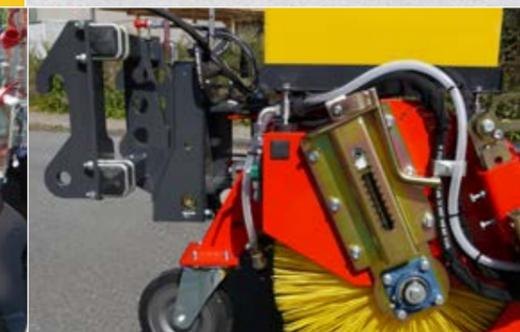
Radladeraufnahme mit Niveausausgleich über Rollenführung
