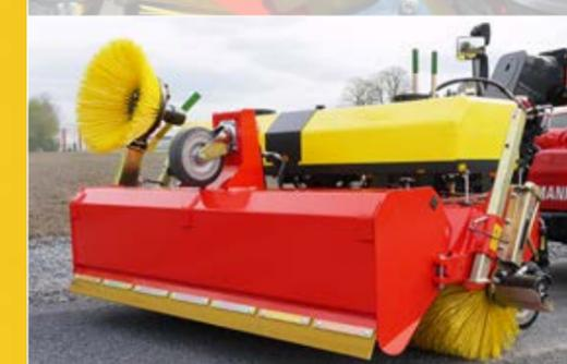
Freikehrmodus, hydraulische Behälterentleerung und drittes Stützrad am Sammelbehälter
