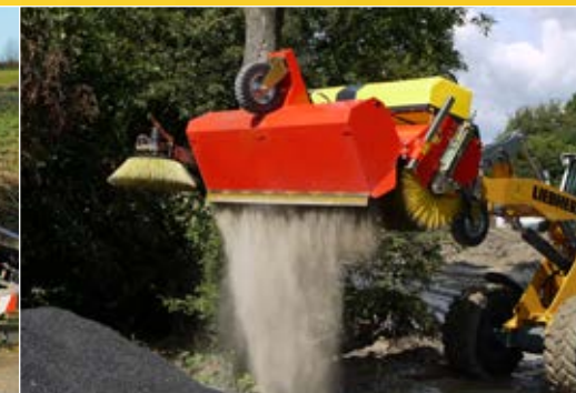
Hydraulische Entleerung des Sammelbehälters
