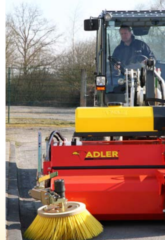
Seitenkehrbesen und Wassertank 240 l als Option
