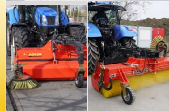
K 750 geeignet für Front- und Heckanbau
