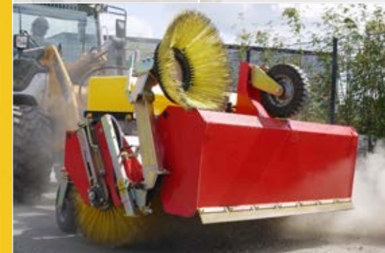
Freikehrmodus und 750 mm Bürstendurchmesser serienmäßig
