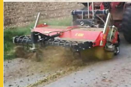
Vorgebaute Kombination mit der Kehrmaschine K 600
