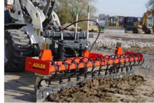
Direktanbau an Schlepper oder Radlader
