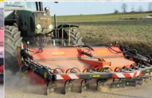
Vorgebaute Kombination mit der Kehrmaschine K 750
