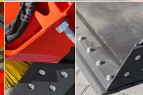
Wechselbare Verschleißmesser unten und seitlich
