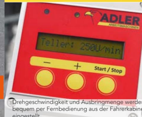
Drehgeschwindigkeit und Ausbringungsmenge werden bequem per Fernbedienung aus der Fahrerkabine eingestellt
