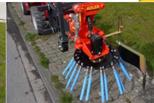
Schwenkarm (mechanisch / hydraulisch) zur Bearbeitung großer Flächen
