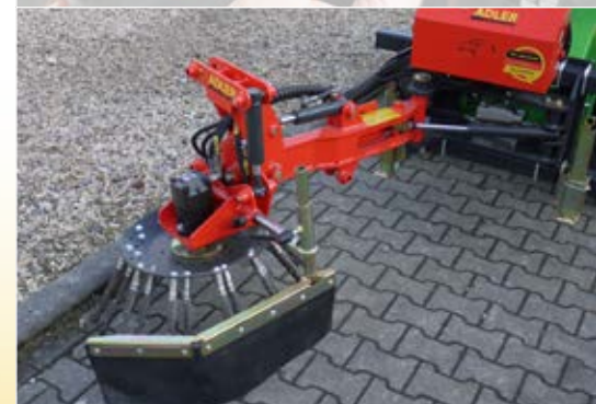
Schwerer Bürstenkopf mit seitlichem Schleuderschutz
