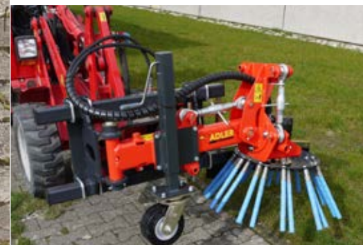
Schwenkarm (mechanisch / hydraulisch) zur Bearbeitung großer Flächen
