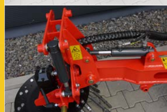
hydraulisch einstellbare Längs- und Querneigung (mechanisch / hydraulisch)
