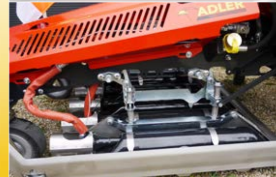
Federnd gelagerte und per Funkfernbedienung höhenverstellbare Infrabox
