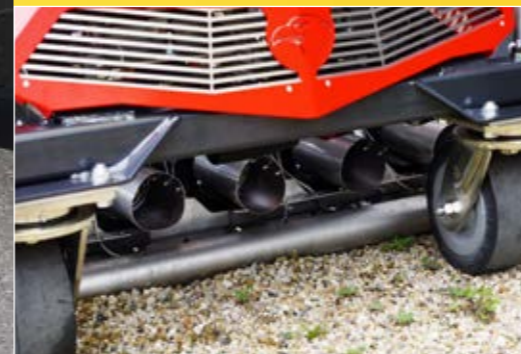
Stoß- und Schwerlastlenkrollen zum Schutz der Infrabox
