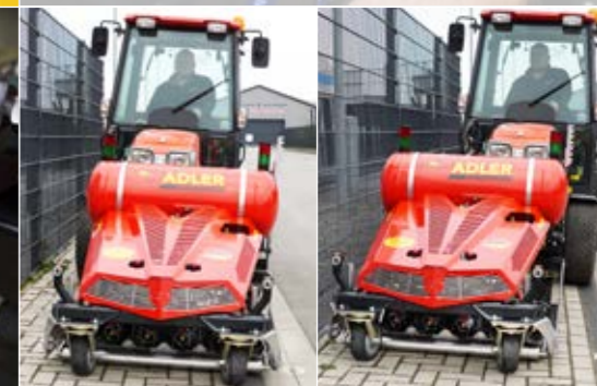
Hydraulische Seitenverschiebung um jeweils 20 cm nach rechts und links
