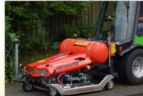
Im Frontanbau auch für kleinere Fahrzeuge geeignet (optional auch für Heckanbau)
