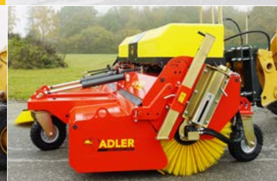
Vier große Lenkrollen (460 mm x 125 mm) sorgen für mehr Stabilität bei der Arbeit.
