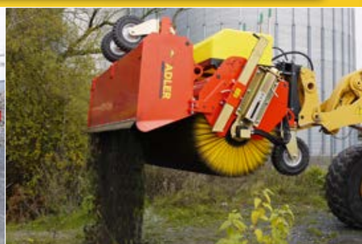
Der besonders „tiefe“ Sammelbehälter erhöht das Kehrvolumen. Natürlich serienmäßig mit hydraulischer Entleerung.
