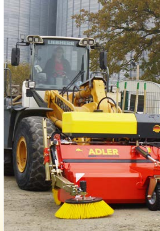
Wenn Wassersprüheinrichtung, dann richtig: Der Seitenkehrbesen wird immer mit Sprühdüse ausgerüstet!
