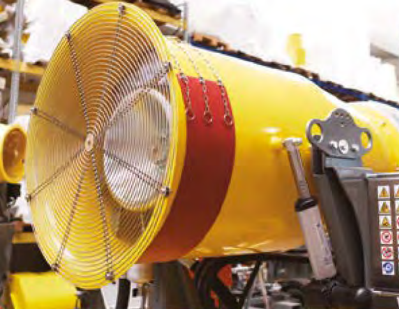
Heizsystem zur Verhinderung des Einfrierens von Konen in extremen Klimazonen
