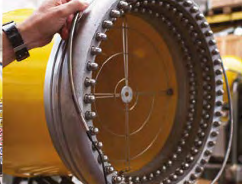
Heizsystem zur Verhinderung des Einfrierens der Krone in extremen Klimazonen
