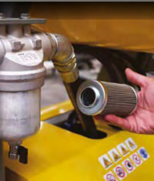
Waschbarer Edelstahlfilter am Eingang des Systems angebracht
