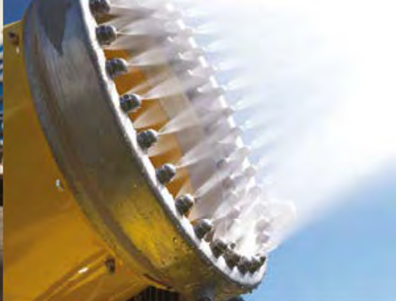
Die Neigung der Düsen und Strömungsgleichrichter ermöglichen eine perfekte Zerstäubung
