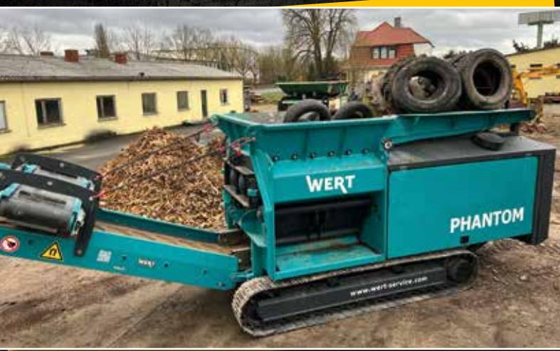
Der "Phantom" wurde entwickelt um den vielseitigsten Anforderungen der Recyclingbranche gerecht zu werden. Dabei zerkleinert er sowohl Stein, Mineralik, Beton als auch Altholz, Grünschnitt, Wurzelholz, Haus- und Gewerbemüll sowie Papier- und Leichtschrott.
