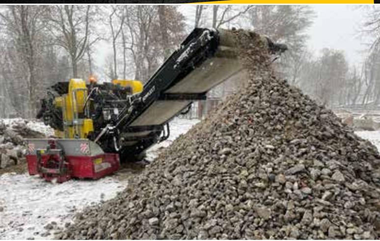
Backenbrecher auf Raupenfahrwerk mit Stahlketten und Gummipads.
