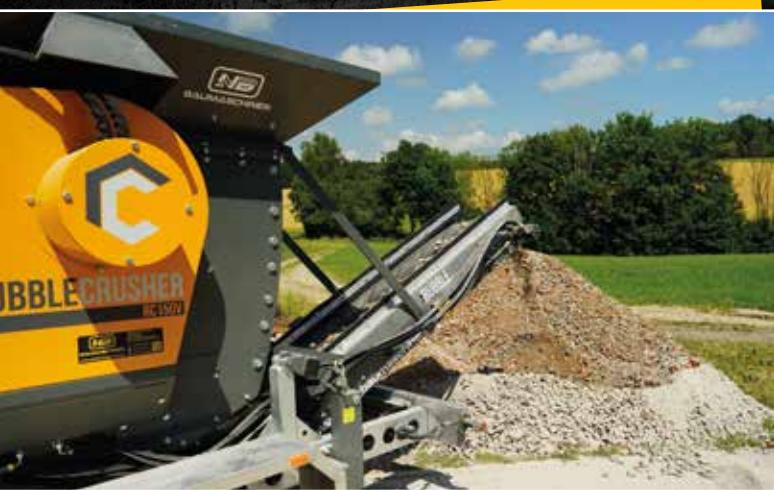
Der Rubble Crusher ist eine robuste mobile Minibrechanlage. Mit einem Gewicht von 3.500 kg kann der Brecher mit einem Geländewagen an die gewünschte Stelle gezogen werden. So kannst Du direkt an der Stelle, an der das Material gesammelt wurde, Brechgut produzieren, welches dann sofort vor Ort eingesetzt werden kann.
